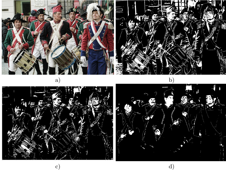
Fig. 3. Resultados de la segmentación de una imagen. a) Imagen original. Segmentación utilizando b) umbralización, c) Naive Bayes y d) MLP
